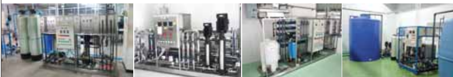
● นวัตกรรมการผลิตน้ำบริสุทธิ์สูง (Ultra Pure Water) ผลิตด้วยระบบ RO. Double Pass + EDI
